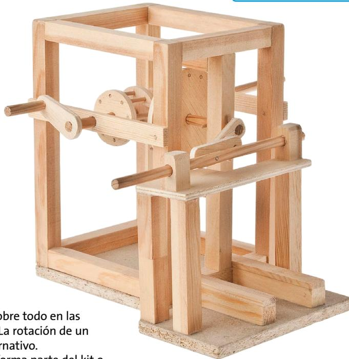
Maqueta I, de Leonardo da Vinci Transformación de un movimiento de rotación en un movimiento alternativo.
